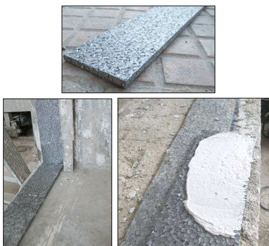
Imágenes 7, 8 y 9 Banda de EEPS y su colocación en el marco portamuestras
